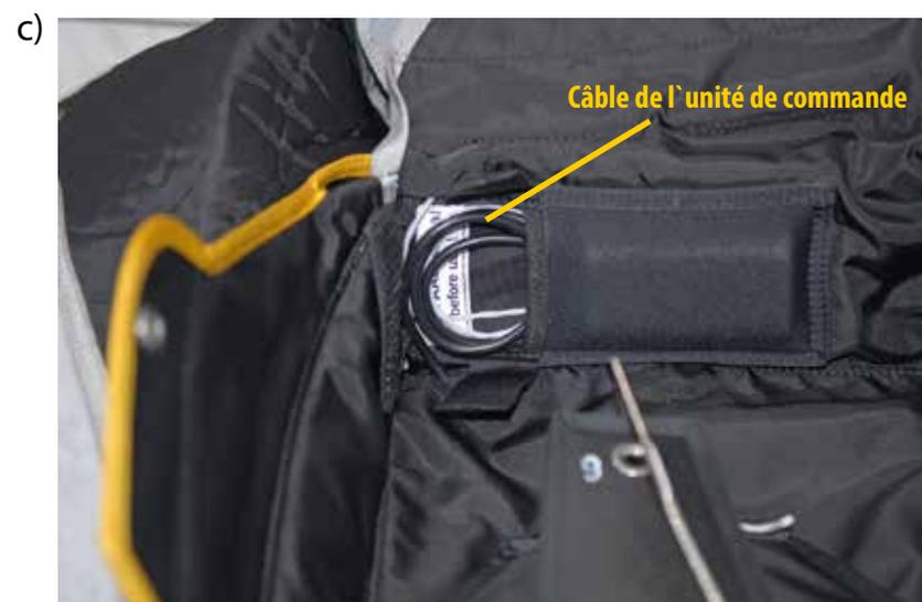
Lors de l'emplacement des câbles, il est nécessaire d'éviter aux ruptures aiguës, aux noeuds et à l'enchevêtrement des câbles. Placez des câbles de manière à ce qu'ils soient suffisamment détendus et qu'il n'arrive pas aux tensions entre les différentes parties de l'appareil !
