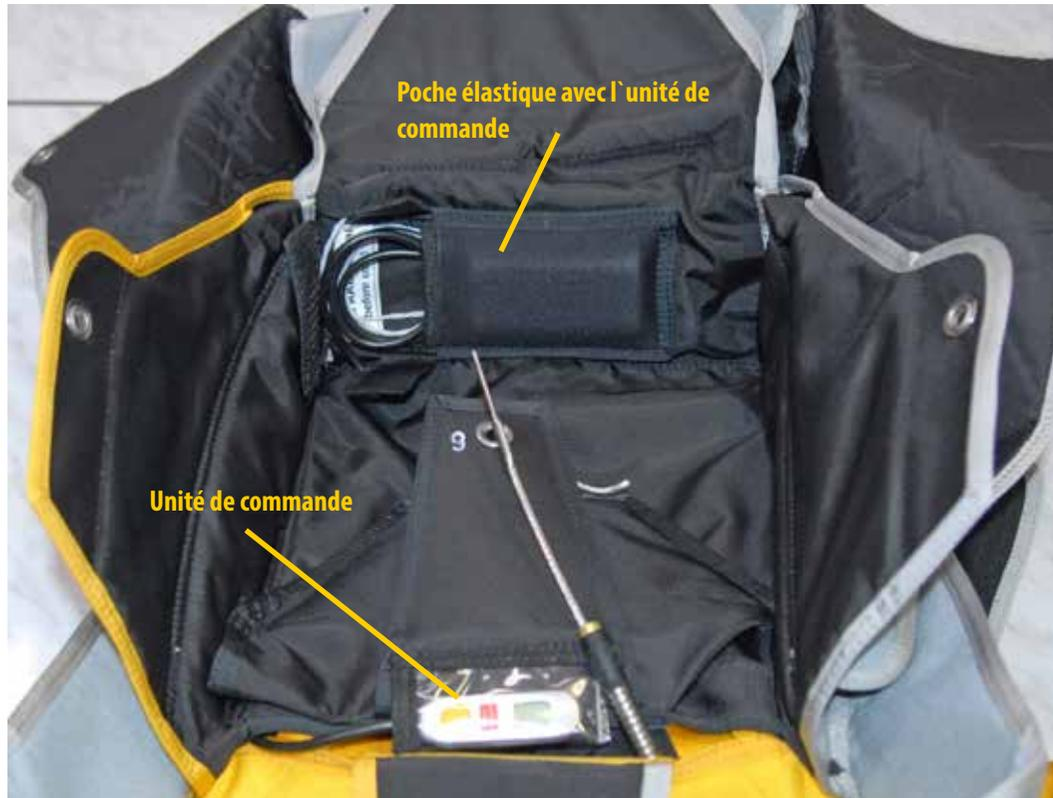
Les câbles **ne peuvent pas** être stockés dans la poche du corps de l'appareil et **ne peuvent pas** se trouver, même partiellement, sous le corps de l'appareil. Il y a un risque de l'endommagement des câbles.
