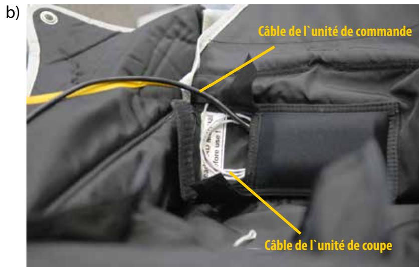
Ensuite, placez toujours le câble fort de l'unité de commande sur le câble mince enroulé. Si l'ensemble pour l'emplacement de l'appareil m<sup>2</sup> est installé de telle sorte que le câble fort est plus haut que le câble mince, enroulez le câble (vu de l'avant) dans le sens inverse des aiguilles d'une montre. Dans l'emplacement opposé de l'ensemble et de l'appareil enroulez-le dans le sens des aiguilles d'une montre.
